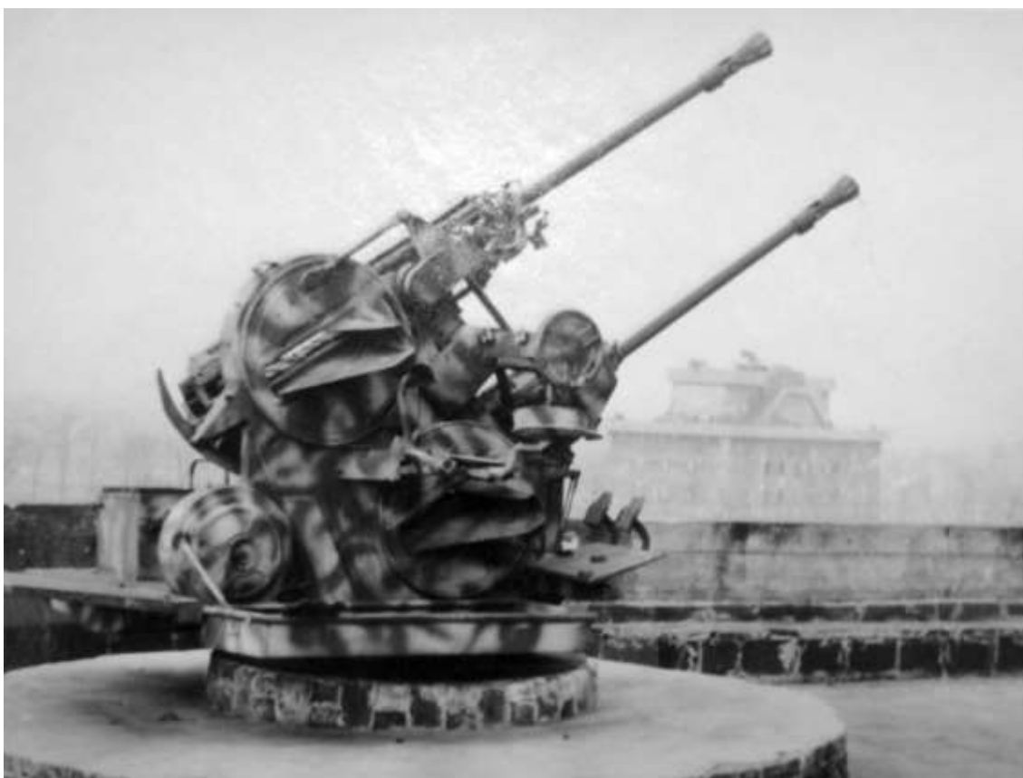
3.7 cm Flakzwilling 43 monteret på Gefechtsturm I i Tiergarten. 3.7 cm Flak 43 var en væsentlig forbedring i forhold til de tidligere 3.7 cm luftværnskanoner. Kanonen havde en maksimal skudhøjde på 6.600 meter og en skudhastighed på omkring 300 skud i minuttet (praktisk). Luftværnskanonen var ikke meget bevendt mod de i foråret angribende Mosquitos, der opererede fra højder på omkring 9 - 10 km højde.
