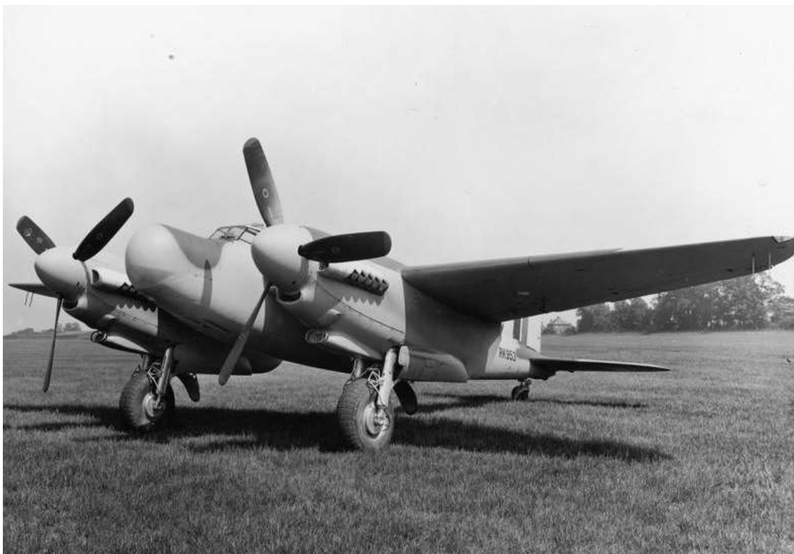
Mosquito NF 30 med SCR 720/729 (AI Mark X) radar på Boscombe Down. Dette fly gjorde senere tjeneste ved No. 151 Squadron.
